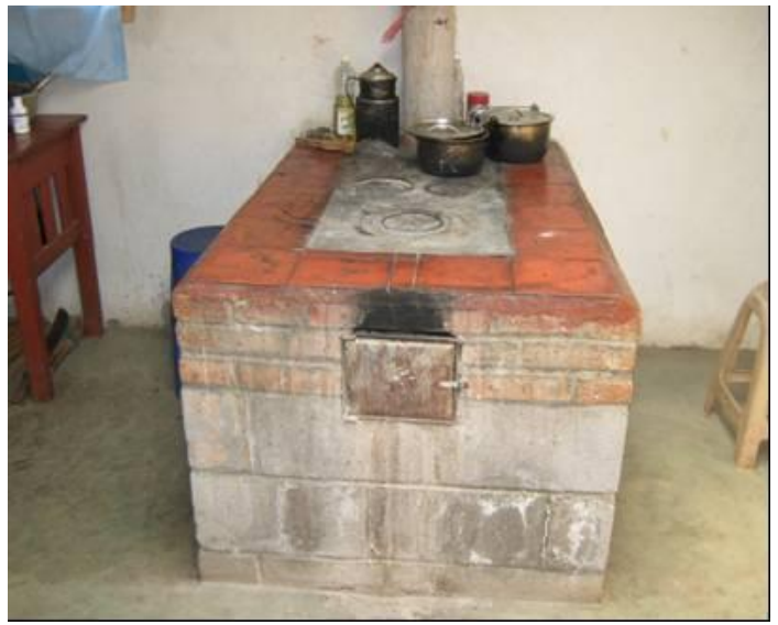
Modelo de Estufa Ahorradora de Leña, tipo plancha mejorada validadas por el FIS e INTECAP. Fotos Esau Guerra.
