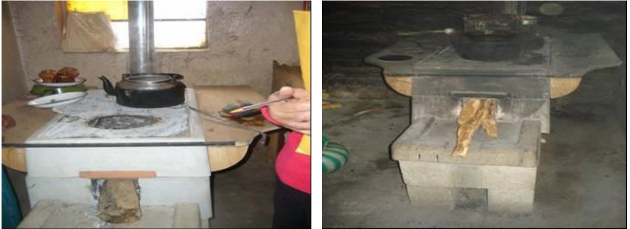
Modelos de Estufa: Tipo Plancha Onil, promocionada por Prorural y Casa Materna de Proyecto Concern International, en Municipios de Huehuetenango. Fotos Thelma Ramírez.
